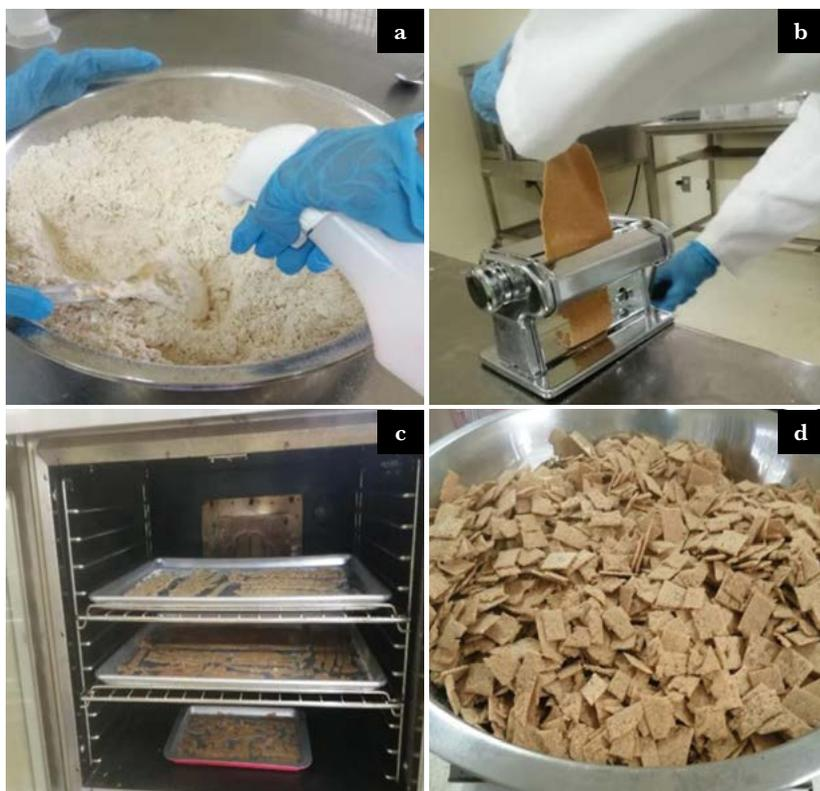
**Figura 1.** Etapas en la elaboración de hojuelas a base de harina de amaranto: a) mezcla de ingredientes; b) moldeo; c) horneado; d) producto final.
