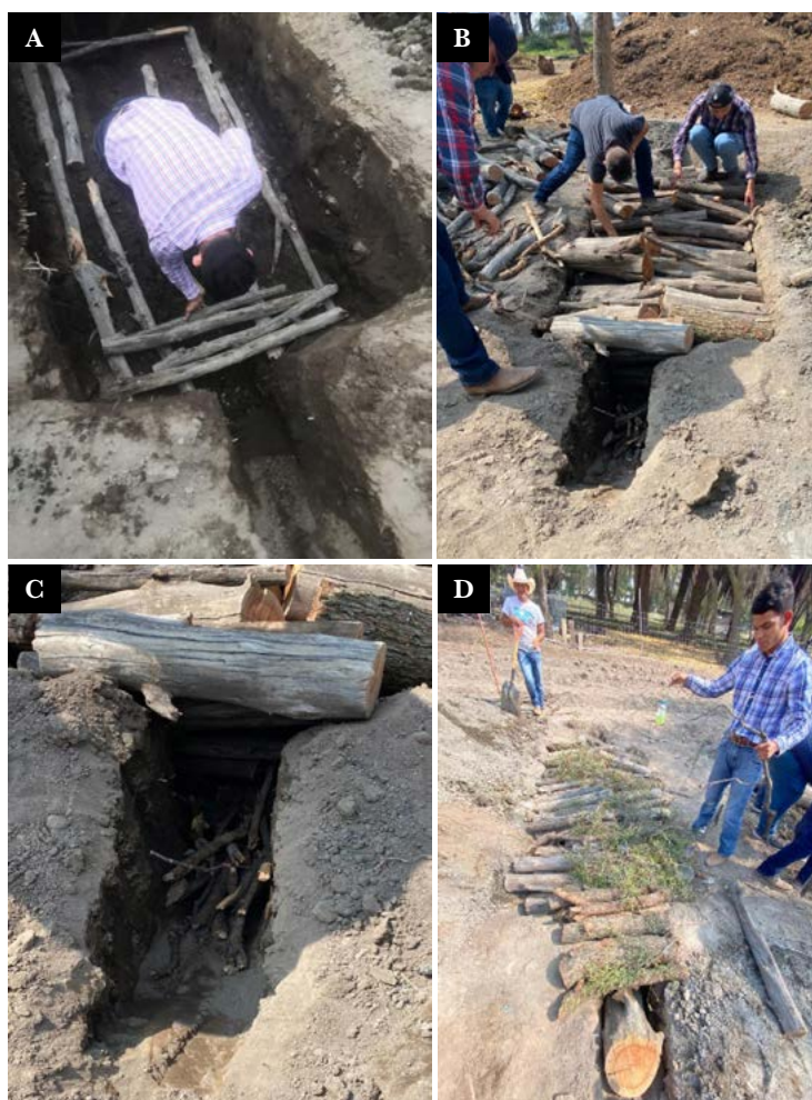
Figura 3. Preparación del llenado de la carbonera. A) Se coloca madera de máximo 5 cm de diámetro para evitar que la leña entre en contacto con el suelo; B) colocación de la leña de forma transversal sobre las varillas; C) borde del acabado de 10 a 15 cm; D) se cubre con forraje verde, ramas sin troncos.
