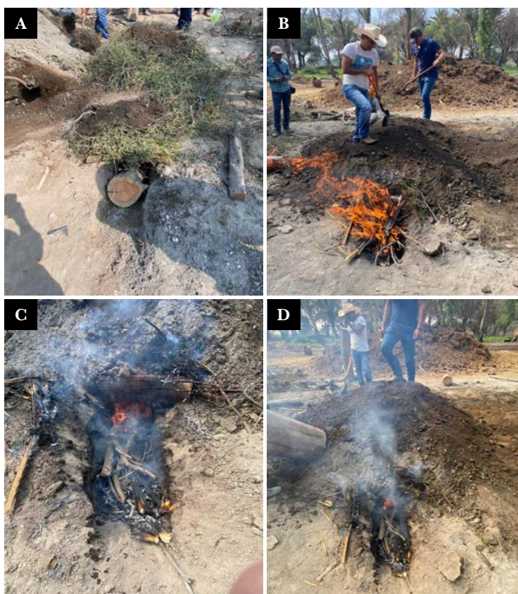
Figura 4. Preparación del encendido de la carbonera. A) se coloca un tronco de madera para que no ingreso el aire, retirándolo una vez que se encienda para generar una succión (respiradero); B) se enciende y se verifica que exista suficientes brazas; C) avance del encendido se comienza a carbonizar y se comprueba el hundimiento; D) se verifica posibles aperturas e ingreso de oxígeno.
