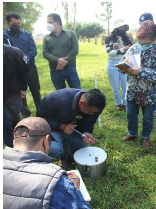
**Figura 3.** Colecta de gas en cámara de acero inoxidable. El gas extraído de la cámara se inyecta en viales de vidrio. Durante todos los muestreos es necesario registrar la temperatura interior de cada cámara con sensores inalámbricos, así como el horario en el que se tomó la colecta.
