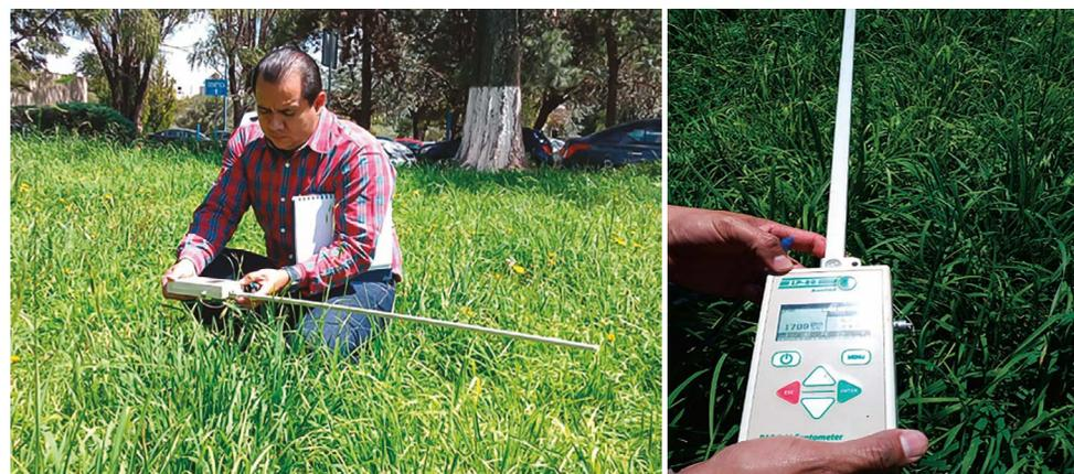
Figura 1. Determinación de la radiación sobre el dosel con ceptómetro lineal.
