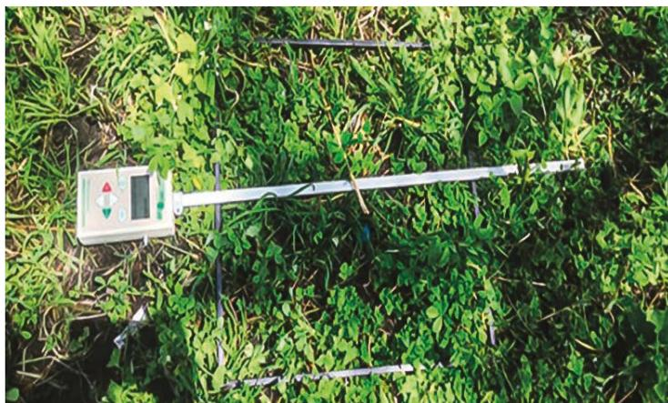
**Figura 2.** Determinación de la radiación sola abajo del dosel (a ras de suelo) con ceptómetro lineal.
